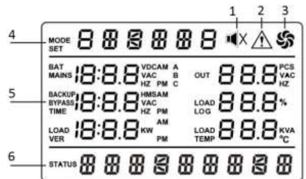
⇒ **Área inferior do display** (6): se não houver nenhuma situação de falha/alarme, esta área mostra a data (imagem na esquerda).
